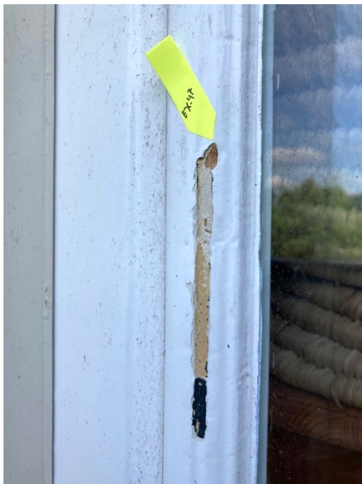
Stratigrafisch onderzoek in situ: kleurtrapje op deurstijl De gele sticker geeft aan waar een verfmonster genomen is
