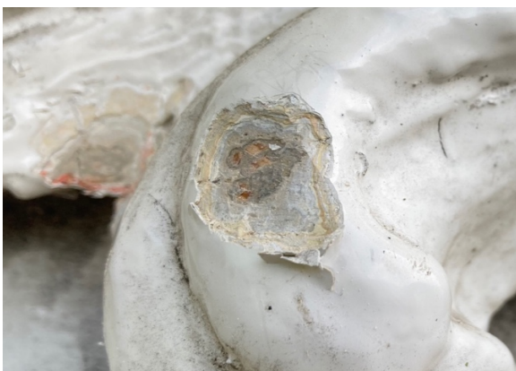
Punctie op het gesneden ornament, die hetzelfde kleurverloop laat zien
