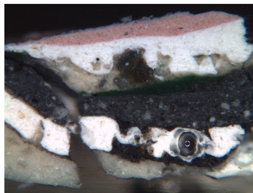
Dwarsdoorsnede van verfmonster VS-EX-43 Gepolariseerd opvallend licht, vergroting 100x Lichte laag (onderin) gevolgd door donkergrijs, groen en huidige roze afwerking
