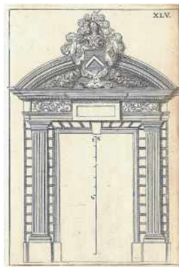
58 Poortje zoals afgebeeld in Regel Van de vijf Ordens der Architecture , door I.B. van Vignola uit 1643 (maar ook afgedrukt in de latere drukken) met Dorische pilasters op een geblokte achtergrond. (Herkomst: collectie rs)
